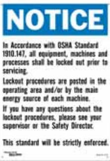
La signalisation permet d'indiquer l'opération en cours, d'identifier l'employé opérant sur la machine et le risque encouru.
